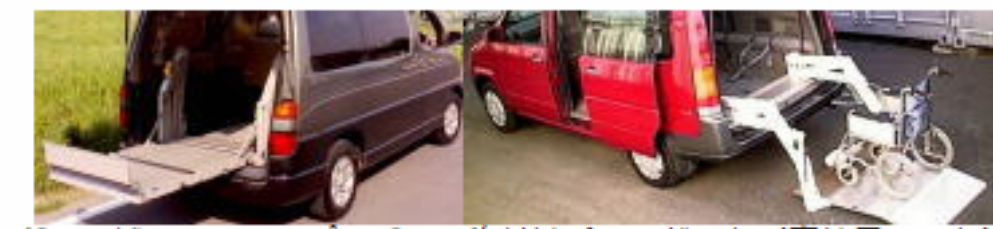
グランピア・ステップワゴンの後付けパワーゲート（車椅子リフト）
